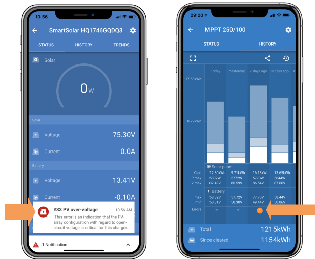
Ein aktiver Fehler und ein historischer Fehler.
