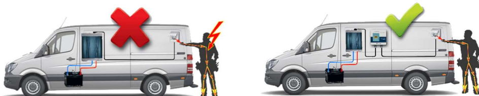
Situation de fonctionnement d'un protecteur d'isolation
