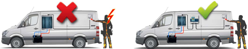
Einsatzsituation des Isolationswächters
