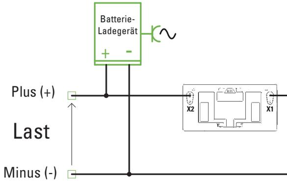
Abbildung 17. Anschließen eines Ladegeräts an die Li-Ionen-Batterie
