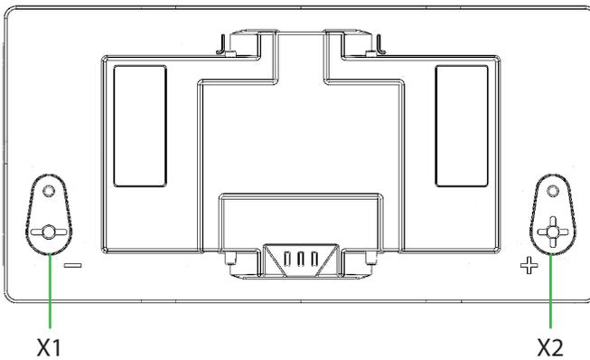
Abbildung 2. Batterieklennen
