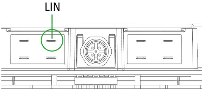
Abbildung 15. LIN-Bus-FASTON-Anschluss
