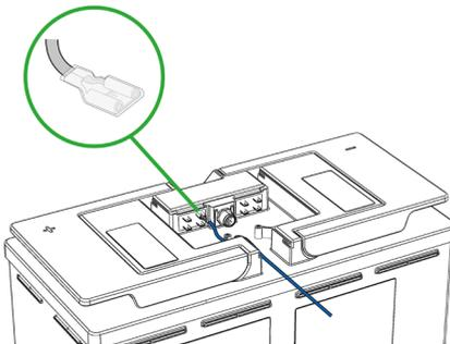
Abbildung 16. Anschluss der LIN-Schnittstelle über den FASTON-Anschluss
