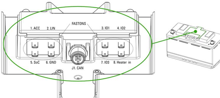
Abbildung 4. Signalschnittstellen
